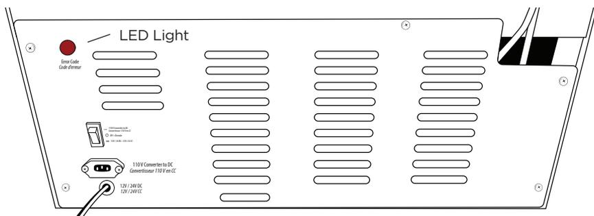
**Retirez les vis de la plaque arrière pour accéder au fusible en ligne de 15 A, au bassin de récupération d'eau et au compartiment du compresseur.**
