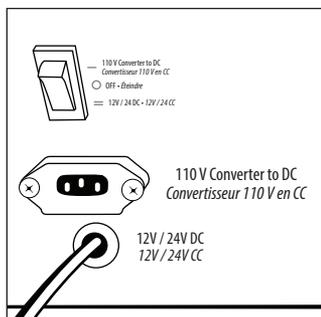
**NOTE:** L'interrupteur doit être «basculé» sur la bonne source d'alimentation, sinon le réfrigérateur ne fonctionnera pas.
